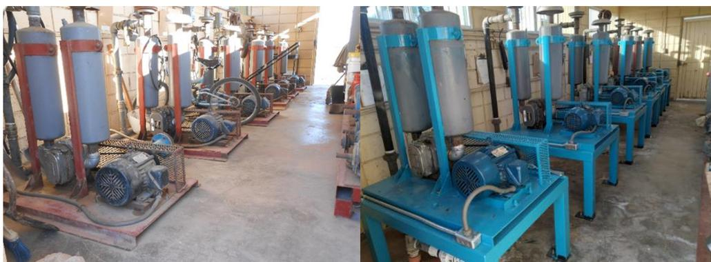
Se desarrolló un Nuevo diseño de equipos oxigenadores flotantes con la finalidad el mantenimiento de los oxigenadores por parte del personal de ICA e Incrementar la operatividad de los mismos en la laguna de oxidación
